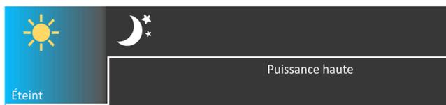
Allumé **puissance haute** lorsque l'éclairage ambiant est inférieur au **seuil crépusculaire**.
