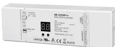
Contrôleur DALI 4 canaux .Compatible DT8. On/Off et Gradation sur 4 canaux, Blanc ajustable (Tunable White) sur 2 canaux ou RGB White sur 1 canal. Sortie 12-36VDC, 4x(60-180W). 2 entrées DALI séparées.
