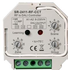
Pilotage DALI par télécommande, compatible DT8. On/Off, Gradation et réglage de température de couleur par groupes et scènes. Jusqu'à 16 groupes et 16 scènes.
